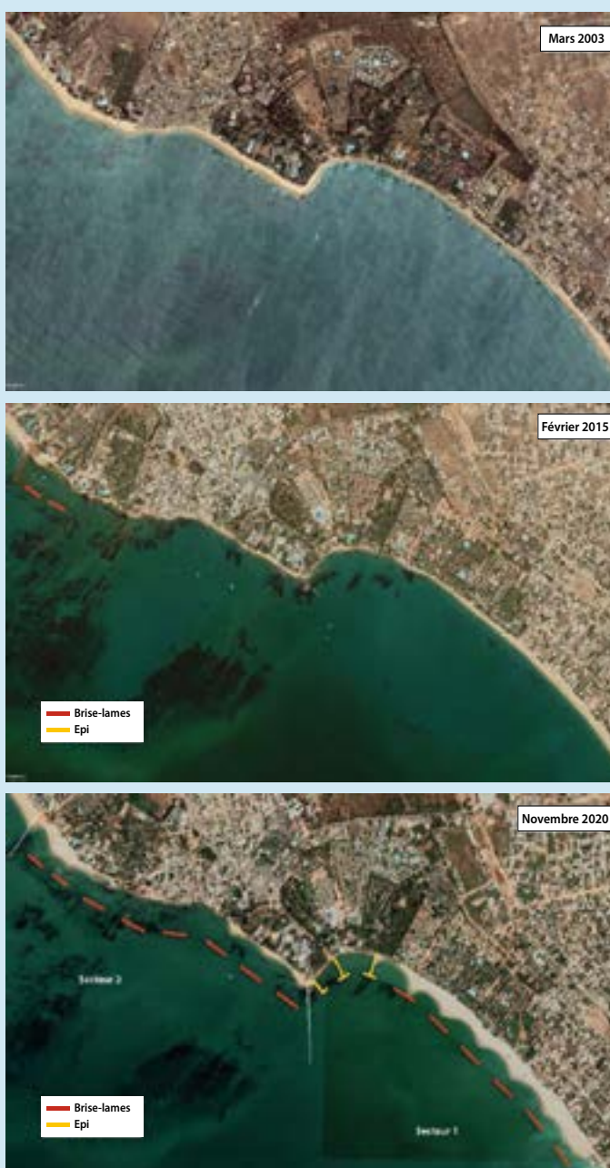
Mise en place de brise-lames dans la zone touristique de Saly Portudal entre 2003 et 2020
