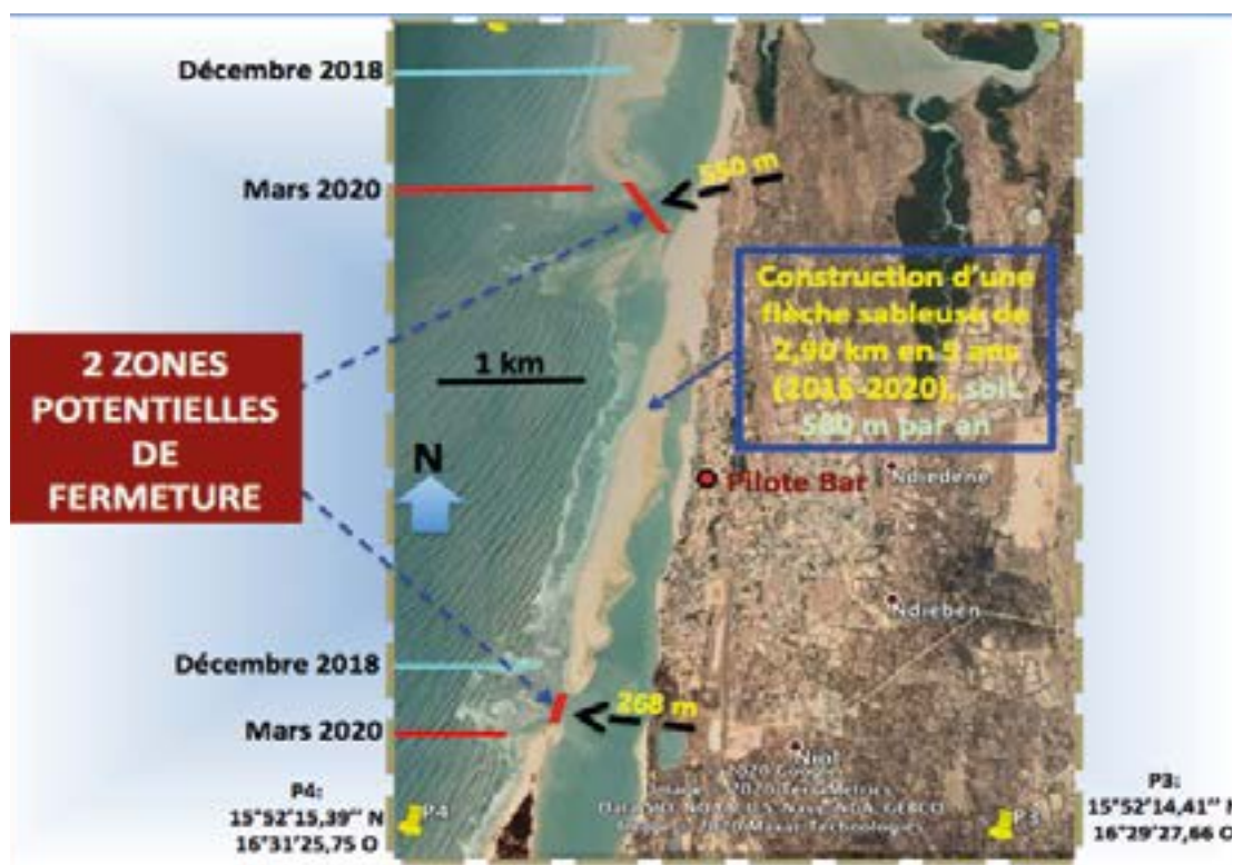
Le système morpho-sédimentaire de Pilote Bar : identification d'une zone potentielle de fermeture de chaque embouchure. Dynamique de construction de la flèche de Pilote Bar et création d'une lagune côtière (Source : études techniques WACA FFEM, CSE 2020).
