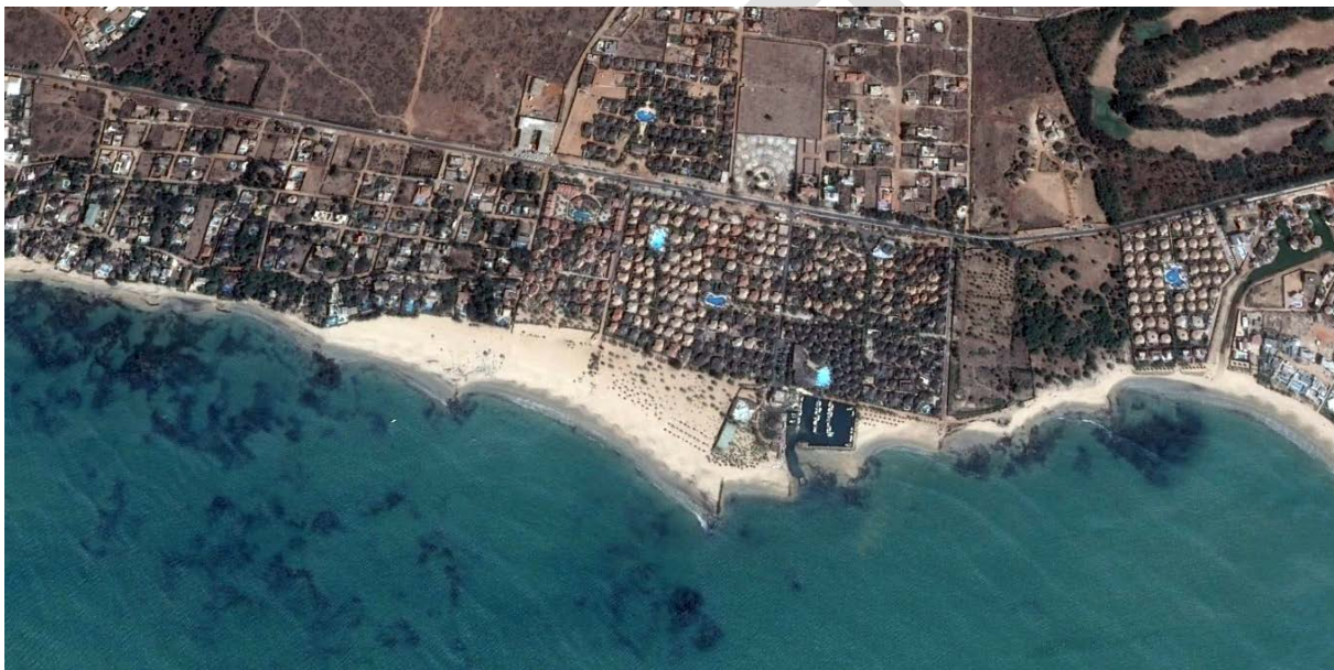
Blocage du transit sédimentaire par une marina sur la Petite Côte au Sénégal
